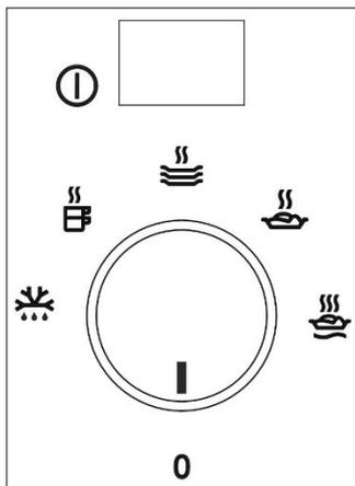
控制面板上有选择钮和 on/off 开关。只能在打开保温抽屉时看到控制面板。
