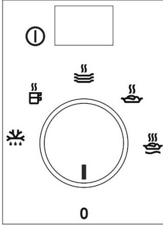
تحتوي لوحة التحكم على مفتاح محدد الوظائف ومفتاح التشغيل/إيقاف التشغيل. وتظهر لوحة التحكم فقط أثناء فتح الدرج.
